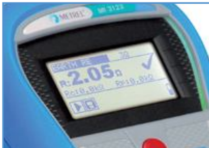
Amplia pantalla LCD con indicador luminoso de pasa/error
